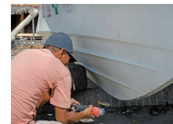
船底の修繕をする船頭。
